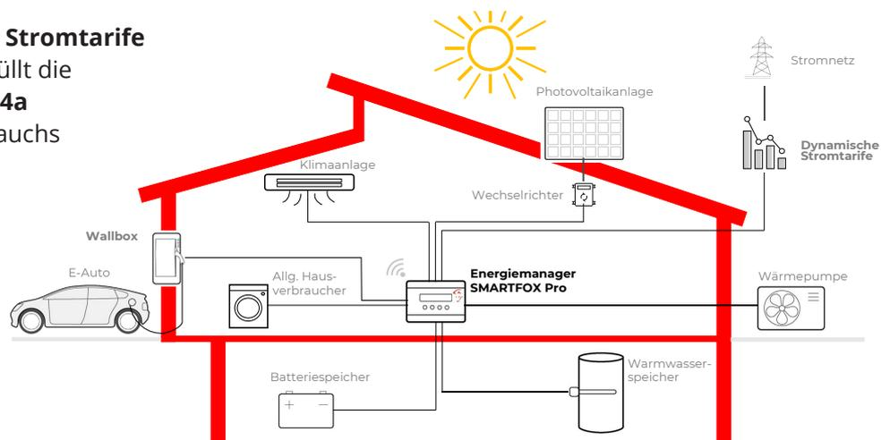
Die SMARTFOX Technik nutzt den Überschuss aus der Photovoltaikanlage nicht nur zum Laden des E-Autos, sondern z.B. auch zur Warmwasser-Bereitung, zum Heizen und Klimatisieren im Haus.
